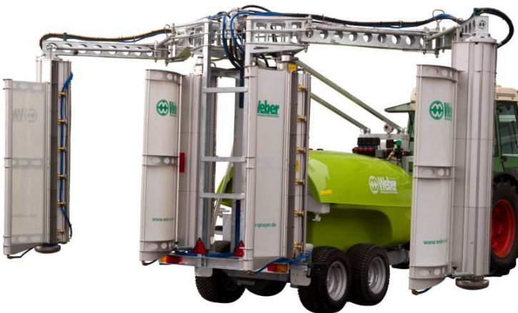
WEBER – descentes avec panneaux récupérateurs
